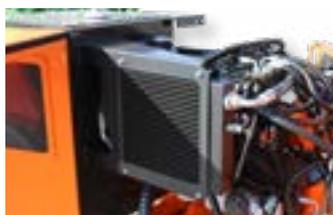
Независимая гидравлическая система с маслоохладителем от перегрева.
