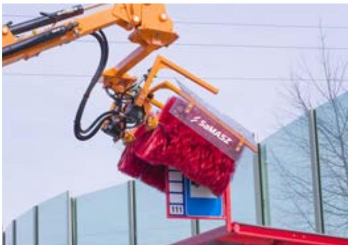
Предназначена для мойки и очистки таких объектов как: знаки и орожные таблички, указательные столбики, дорожные ограждения со светоотражателями.
