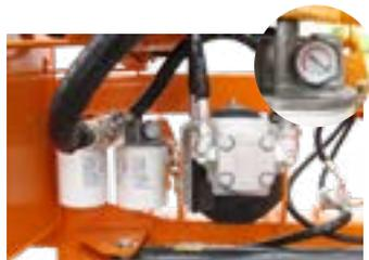
Маслоотделяющие фильтры со встроенным показателем загрязнения, защищают гидронасос от механических повреждений.
