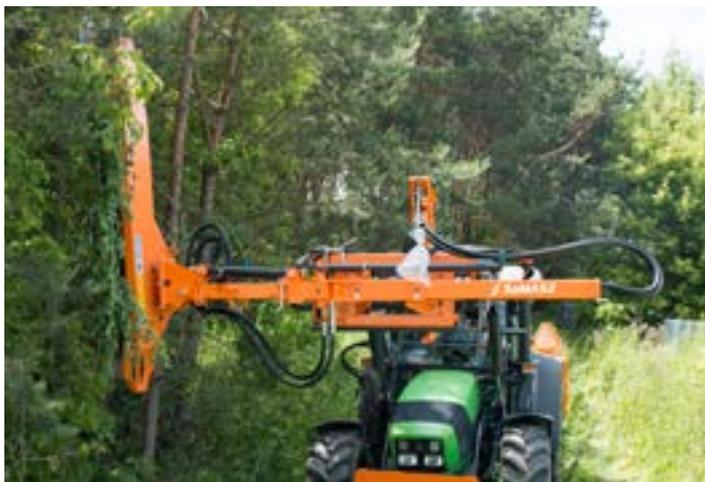
Штанга Fisher представляет собой телескопическую рабочую рукоять, на которую можно установить циркулярную пилу РТ3-190F, РТ4-250F или ножничный кусторез PG 150F, PG-200F.
