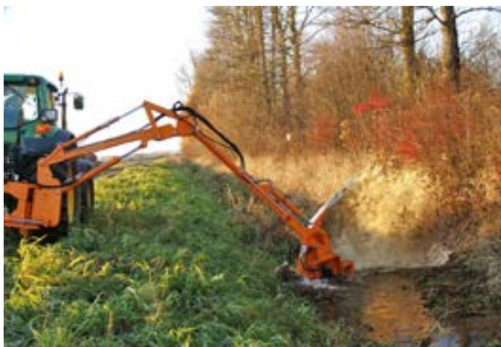
Предназначен для очистки дренажных канав от ила, растений и песка, нанесенного водой.
