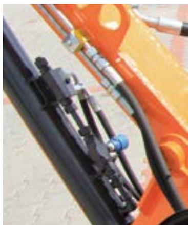
Гидравлический ригель на главном цилиндре вместе с регулируемым дроссельным клапаном.
