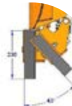
Механизм отклонения лемеха позволяет лемехам отклоняться до угла 45^\circ , что позволяет амортизировать удары и проходить над препятствием высотой до 24 см.
